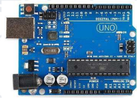
Рисунок 2.4 – Плата Arduino Uno
