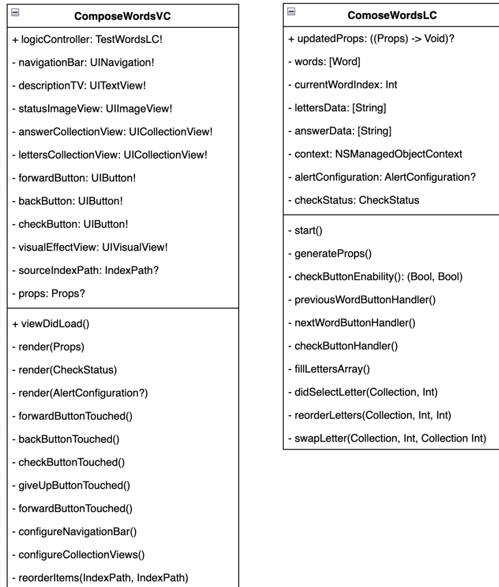
Рисунок 2.10 – Діаграма класу ComposeWordsVC (UI) та супутнього класу ComposeWordsLC (Logic controller)
