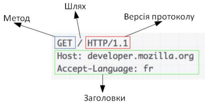
Рис. 1.2. Основні частини, з яких складається HTTP запит
