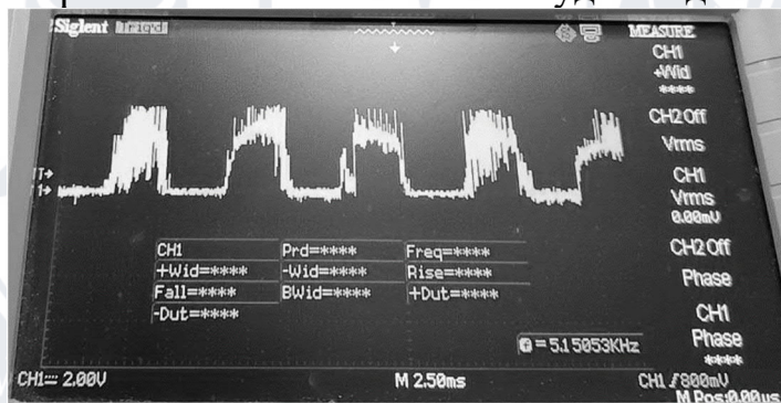
Рисунок 3.9 – Сигнал з диму на виході неінвертуючого операційного підсилювача розташованого після амплітудного детектора.
