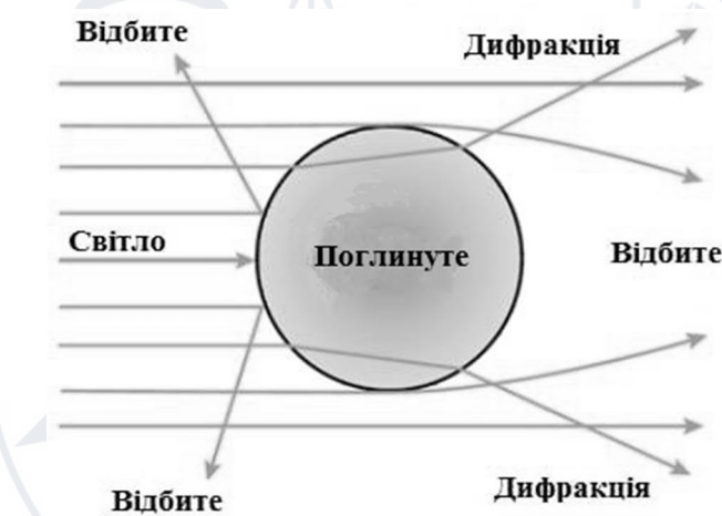
Рисунок 2.1 – Взаємодія світлового потоку і пилу
