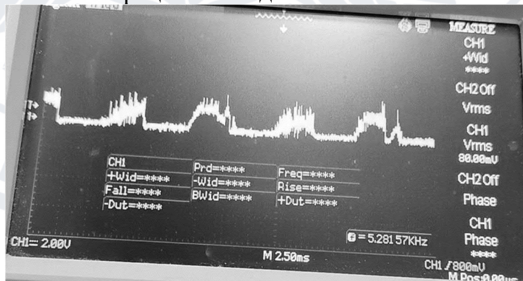
Рисунок 3.6 – Сигнал без диму на виході амплітудного детектора.
