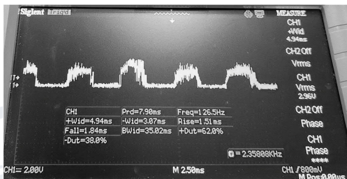
Рисунок 3.7 – Сигнал з диму на виході амплітудного детектора.
