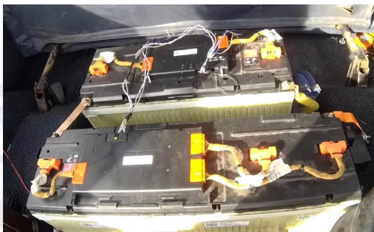
Рис.3.14. Підключення модулів ВМВ
