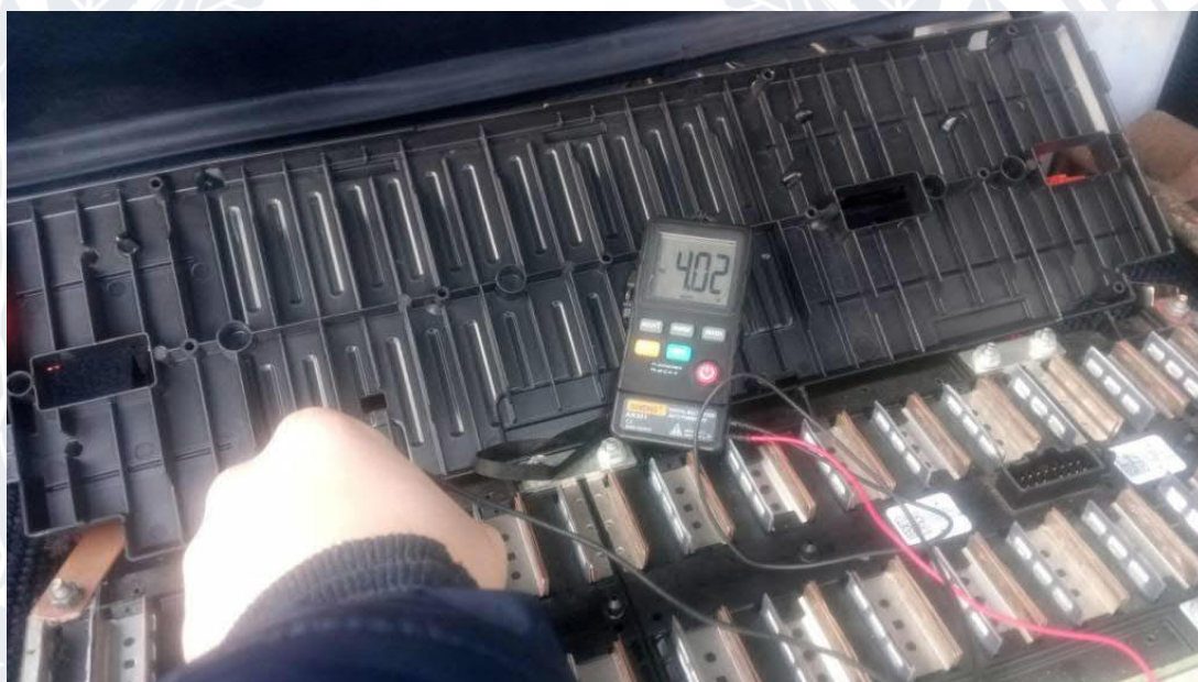
Рис.3.4. Перевірка напруги на елементах батареї
