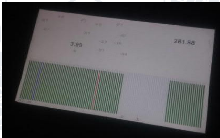
Рис.3.13. Тестування відображення напруг елементів батареї
