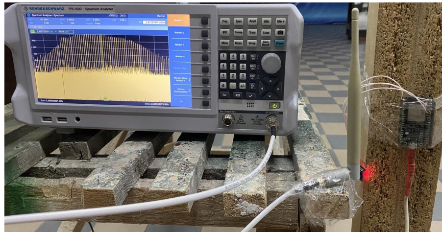
Рисунок 3.2 – Підключення антени до вихідного порту направлено-го зв'язувача
