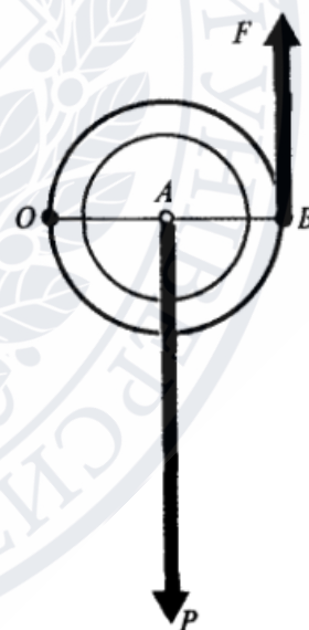
Рис. 3.7. Принцип дії нерухомого блоку.
